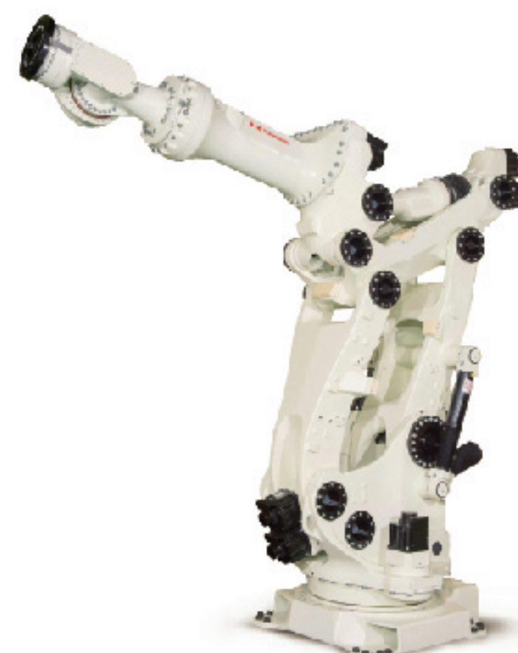
超大型通用机器人~1,500kg负载
