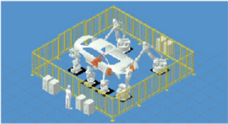
可以同时检验多台机器人的动作
