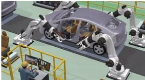
「Successor」是一种新开发的系统，可通过远程操作来实现远程协调。同时通过远程操作可以实现在各行各业应用机器人，可对应涉猎广泛的川崎机器人！
